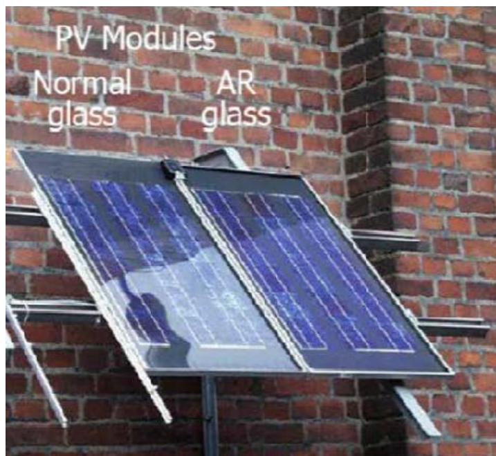
Figura 23: Le due immagini dimostrano in modo lampante come, al contrario di un vetro comune (normal glass), il vetro anti-riflesso (Anti-Reflecting glass) che riveste i moduli fotovoltaici (Photo Voltaic Modules) riduca drasticamente la riflessione dei raggi luminosi.
